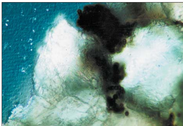
Микрофотографии петрографических шлифов мрамора с грибными колониями, поселившимися в структурной трещине. На левой фотографии видны четкообразные гифы (увел.400), а на правой — многочисленные пигментированные колонии, развившиеся не только на поверхности, но и в глубине светлого мрамора.
